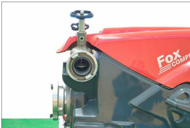
Abb. E05: Richtige Knaggenstellung TS-Ausgang (ÖBFV)
