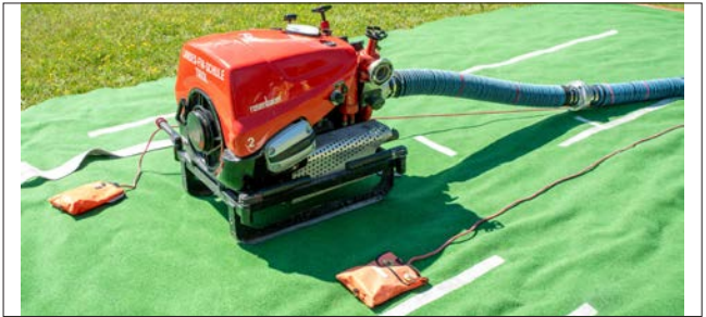
Abb. 40: Ablegen des Leinenbeutels mit der Ventilleine (LFV Stmk. BR d.V. Franz Fink)
