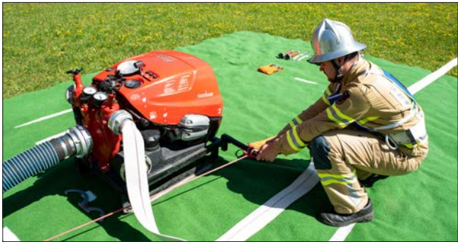
Abb. 39: Richtiges Befestigen der Saugschlauchleine (LFV Tirol)
