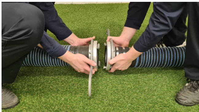
Abb. 29: Kuppeln der Saugschläuche mit angesetzten Kupplungsschlüsseln (NÖ LFV)
