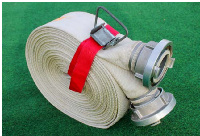
Abb. 2: Doppelt gerollter Druckschlauch (BFKDO Oberwart)
