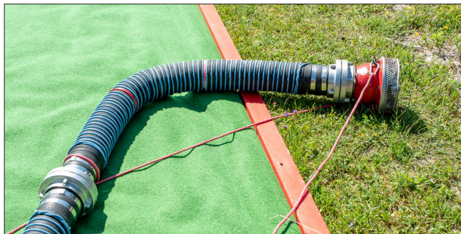
Abb. 37: Richtiges Ablegen des Saugkorbes jenseits der Wassermarkierung (LFV Tirol)
