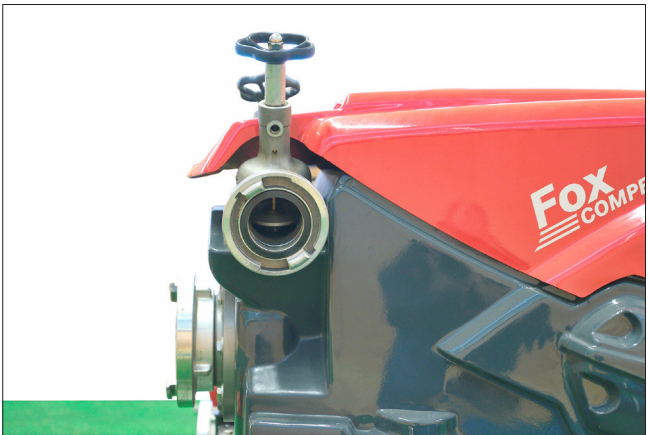
Abb. E05: Richtige Knaggenstellung TS-Ausgang (ÖBFV)
