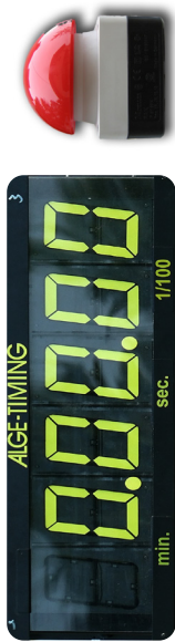
Abb. 62: Start-Taster / Stoppuhr mit Displayanzeige / Stopp-Taster
