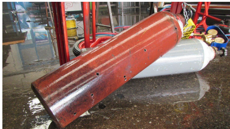
Abbildung 26: Beschussbild nach dem Aufschießen durch EKO-Cobra (Presseteam FF Wr. Neustadt)
