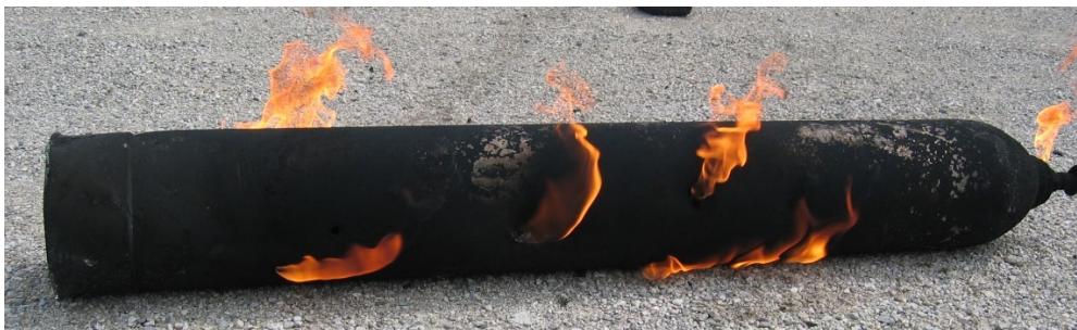
Abbildung 25: beschossene Acetylenflasche (Stadt Wien | Feuerwehr)
