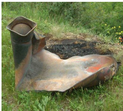
Abbildungen 17, 18, 19 und 20: Auswirkungen des Zerknalls einer Acetylenflasche (Stadt Wien | Feuerwehr)
