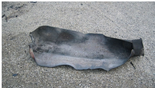
Abbildungen 17, 18, 19 und 20: Auswirkungen des Zerknalls einer Acetylenflasche (Stadt Wien | Feuerwehr)
