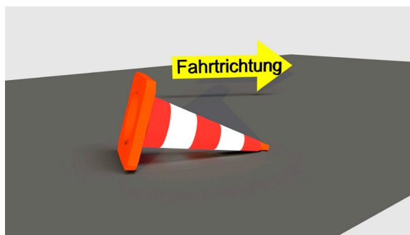
Abbildung 51: Ein umgelegter Verkehrsleitkegel zeigt in die zu fahrende Richtung
