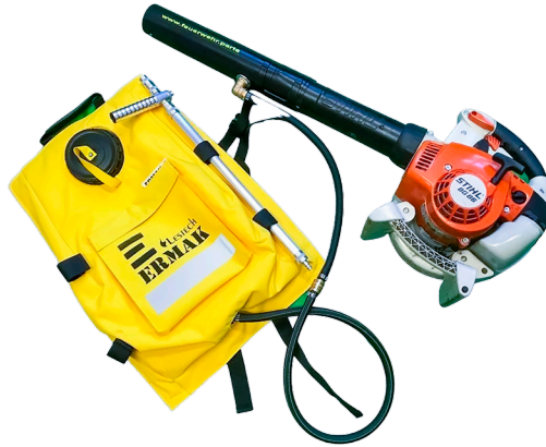
Abbildung 34: Laubgebläse in Kombination mit einem Löschrucksack
