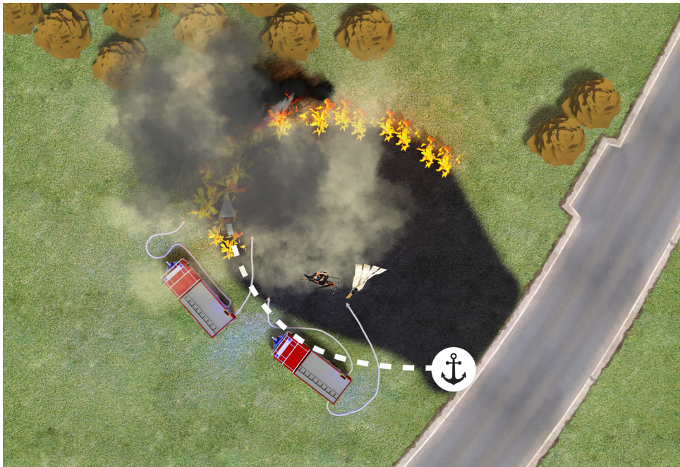
Abbildung 61: Tandemangriff mit wasserführenden Löschfahrzeugen aus dem Grünen auf die Flanke
